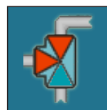
3-putni preklopni ventil sa prikazom otvorenog i zatvorenog voda
