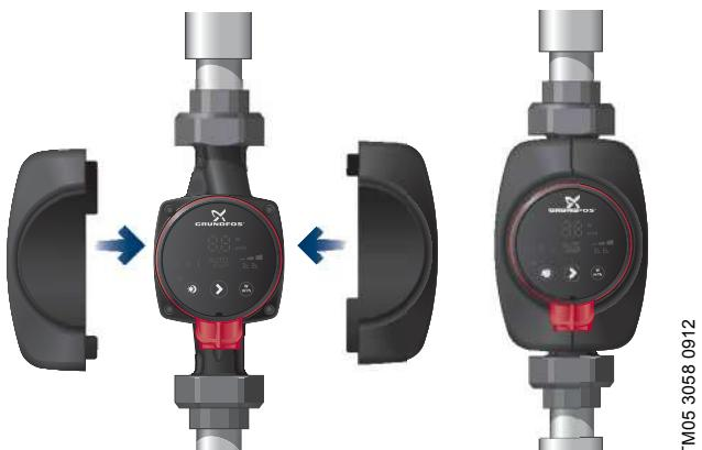
**Slika 8** Izolacija kućišta crpke
