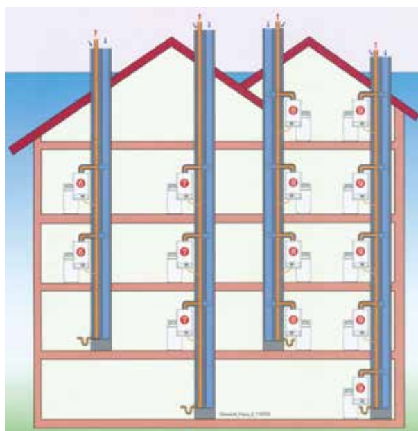
Dvokanalni LAS, paralelni.
